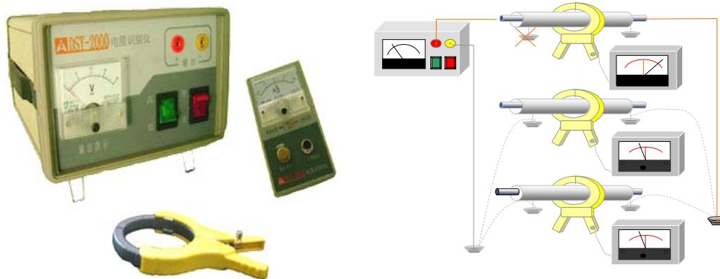
DSY—2000 电缆识别仪是 DSY 电缆识别仪的第三代产品，它总结并克服了第一代霍尔感应单点接触式识别仪 (DSY-9) 只能判断大小而不能判断方向并在强磁场下无法工作的缺陷，同时克服了第二代 U 型插槽式识别仪 (DSY-1000) 的因漏磁而影响识别的缺陷。由于有了方向及大小的双重判别使得 DSY—2000 型电缆识别仪的识别正确率达到了 100%。
