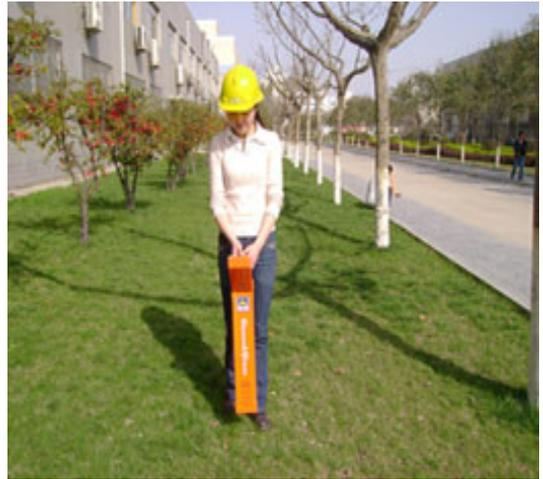
此测试方法适用于电缆的对地短路故障，由发射机对电缆施加特殊频率的高压，电压通过电缆产生的电流经电缆故障点入地，在故障点周围产生电压梯度，通过 'A' 字架的两根电极沿电缆路径测量电位的变化情况。当靠近故障点时，电位差将迅速增加，并在临近故障点前达到最大值，继续前行信号出现大 - 小 - 大变化点，在这一变化中的最小点即是故障点。
